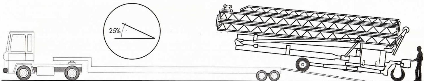
La **Clever Crane** in fase di carico e scarico dal bilico supera, in autonomia, pendenze del 25%.
