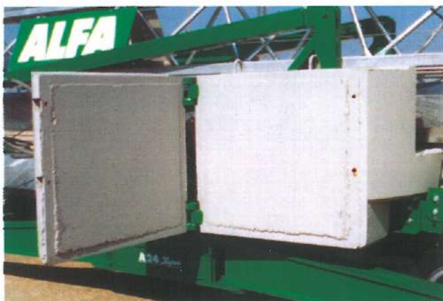
ZAVORRA A BORDO CON INGOMBRO VARIABILE: M. 1,90 ▶ 2,40 STANDARD BALLAST WITH VARIABLE WIDTH: M. 1,90 ▶ 2,40
