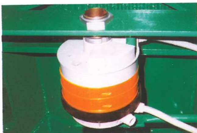
COLLETTORE ELETTRICO SENZA LIMITATORE DI GIRI ELECTRICAL SLIP RING WITHOUT REVOLUTIONS LIMIT
