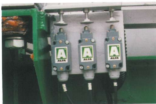
LIMITATORI DI CARICO E MOMENTO IN BASSO (DPR 547 E CIRC. 77) LOAD AND MOMENT LIMITING DEVICES IN LOW POSITION (AS PER RULES)
